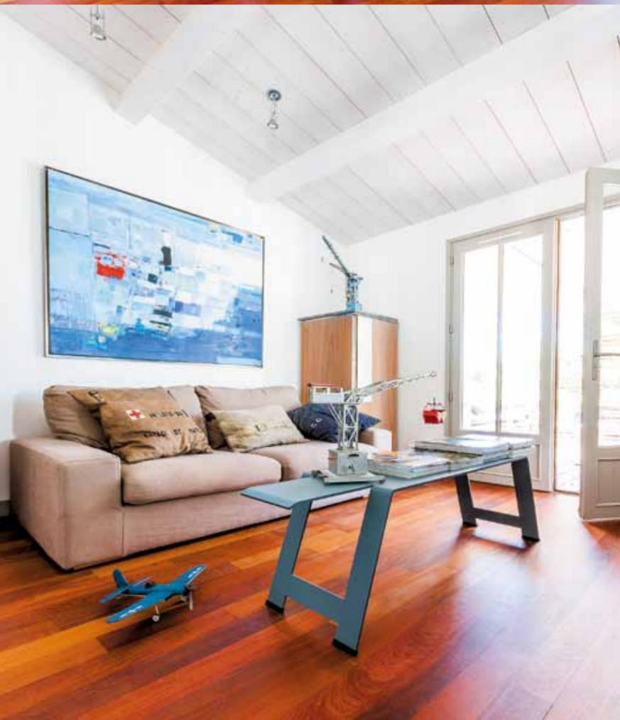
CETTE TABLE BASSE EST EN RÉALITÉ LE BANC ORIGAMI DE FERMOB, CLIN D'ŒIL À L'ART ASIATIQUE DU PLIAGE. L'ASSISE ET LE PIÈTEMENT SONT OBTENUS PAR LE DÉCOUPAGE ET LE PLIAGE D'UNE SIMPLE TÔLE D'ACIER. UNE TECHNIQUE PERMETTANT D'OPTIMISER LA MATIÈRE PREMIÈRE CONSOMMÉE ET DE GARANTIR LE "ZÉRO DÉCHET". UN JEU D'ENFANT.
